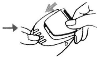
5. После очистки нанесите немного смазочного масла на лезвие, затем установите лезвие на место. Вы услышите щелчок, подтверждающий, что лезвие успешно установлено.
